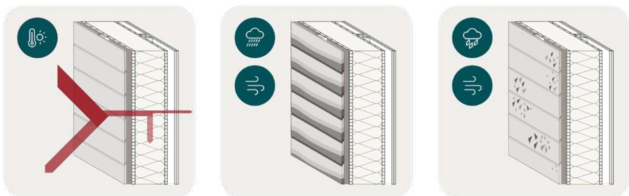
Abb. 54 Auswirkungen der Wetterelemente auf die hinterlüftete Holzleichtbaukonstruktion. Links: Hitzeeintrag in das Bauteil. Mitte: Feuchteintrag infolge Schlagregen. Rechts: Schäden an der Holzoberfläche infolge Hagel und Sturm.
